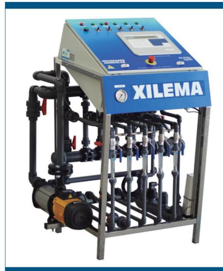
► Todos los modelos se fabrican con chasis en acero inoxidable, cuadros herméticos, materiales anticorrosivos, fácil acceso a sus componentes. Bajo demanda, los equipos pueden trabajar con fertilizantes líquidos concentrados.
